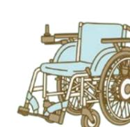
軽量のモーター等を搭載した電動車いすです。ジョイスティック等で操作し、電動と手動の切り替えが可能です。
